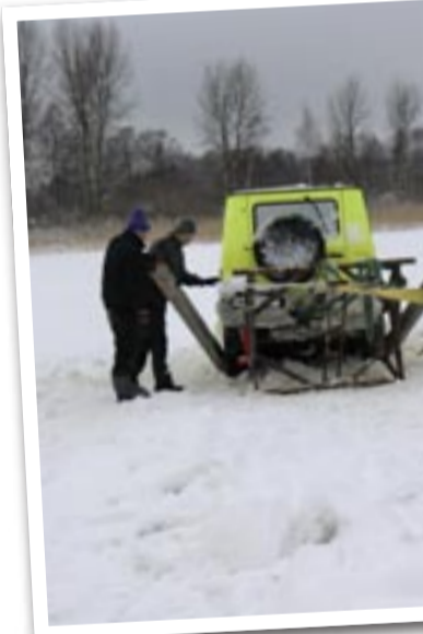
En specialsvetsad ställning fästes i dragkroken och ett kraftigt spel krävdes för att dra upp bilen.
