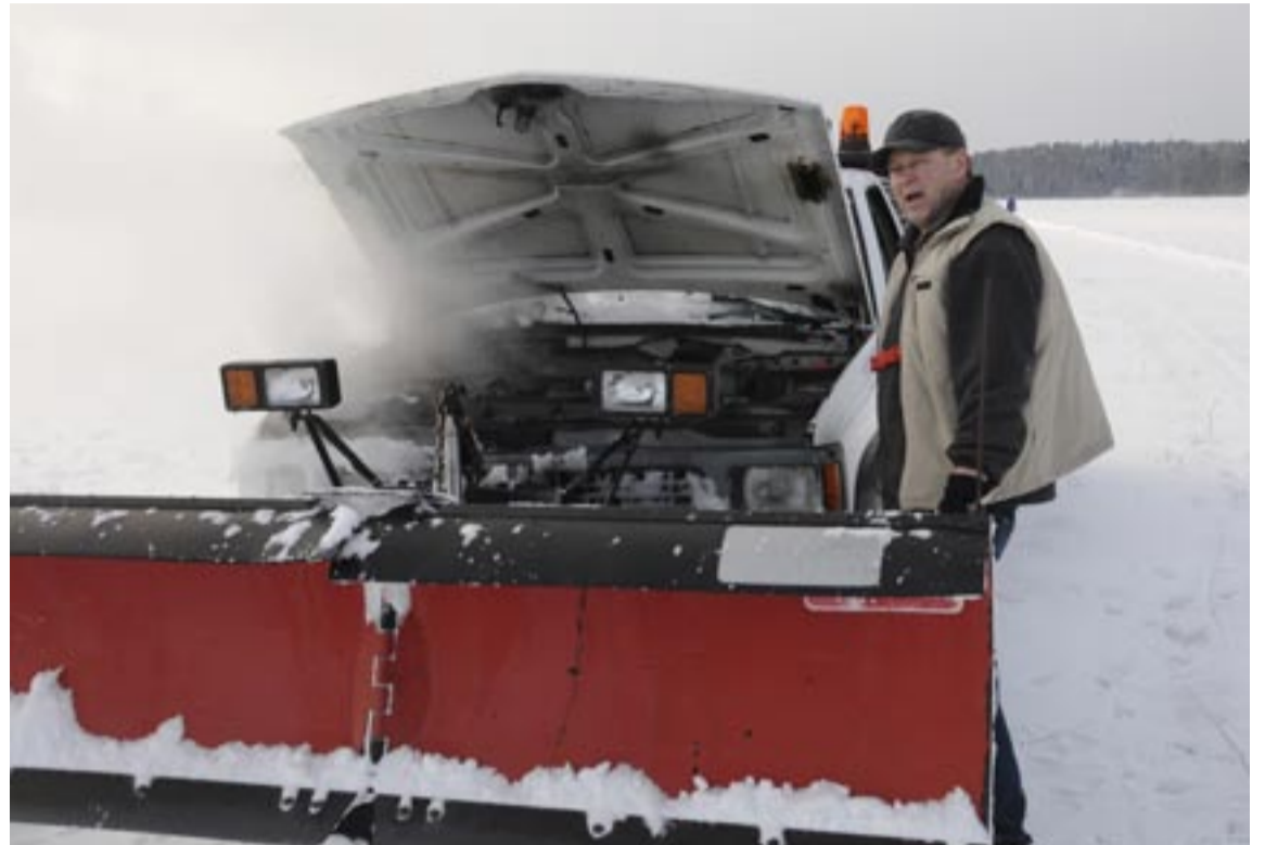
Den här bilen är gjord för varmare klimat. Oljekylaren täpps igen och gör att motorns kylare inte får luft. Då kokar den och man får ta en paus och fylla vätska.
